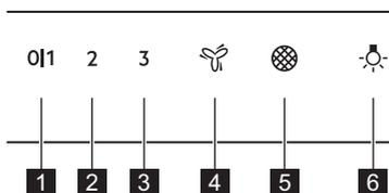
**1** **Første hastighed / slukket** - Motoren skifter til første hastighedsniveau. Et tryk mere slukker for emhætten.
