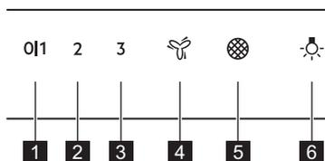
**1** **Първа скорост / Изкл.** - Моторът превключва на първа скорост. При повторно натискане уредът се изключва.
