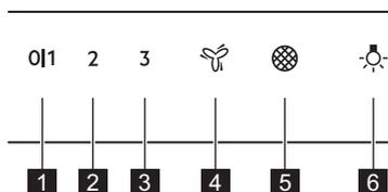
**1** **Primeira velocidade/Desligado** - O motor muda para o primeiro nível de velocidade. Ao premir a segunda vez desliga o aparelho.
