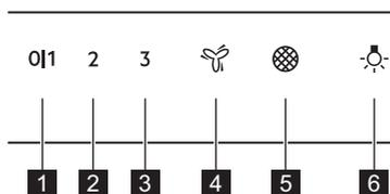
**1 Prva brzina / Isključeno** - Motor prebacuje na prvu razinu brzine. Drugi pritisak isključuje uređaj.
