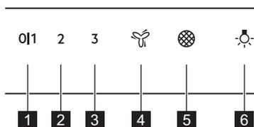
**1** **Первая скорость / Выкл** - Двигатель включается на первом уровне скорости. Второе нажатие выключает прибор.
