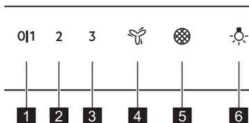
**1 Prva hitrost/Izklop** - Motor se preklopi na prvo stopnjo hitrosti. Z drugim pritiskom izklopite napravo.
